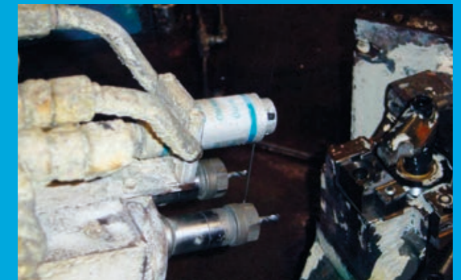
Werkzeug-Bruchkontrolle: beidseitiges Abtasten
