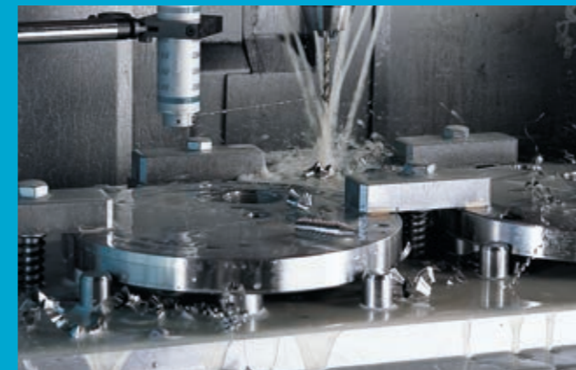
Werkzeug-Bruchkontrolle: einseitiges Abtasten
